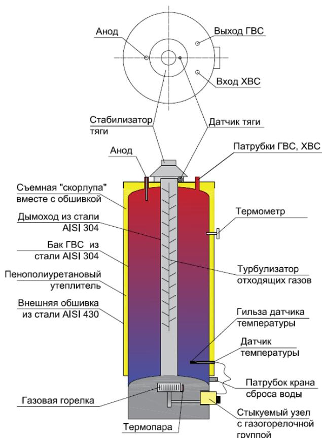
Для усиления процесса теплообмена в трубе установлен турбулизатор отходящих газов, который создает сопротивление движению отходящих дымов и создает турбулентное течение дымов.
