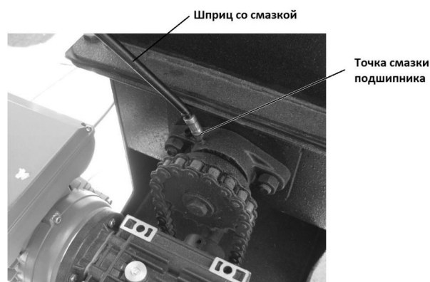
Рис. 8. Смазка подшипников шнековой подачи.
