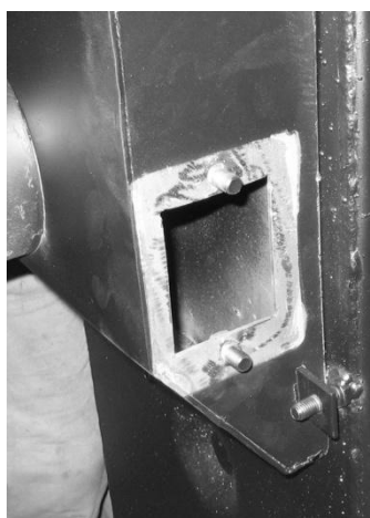
Рис. 10. Отверстие для чистки адаптера дыма.
