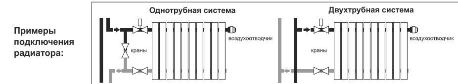
После окончания монтажа необходимо провести испытание смонтированного радиатора согласно пункту 4.1. СНиП 3.05 01-85 и составить Акт ввода радиатора в эксплуатацию.
