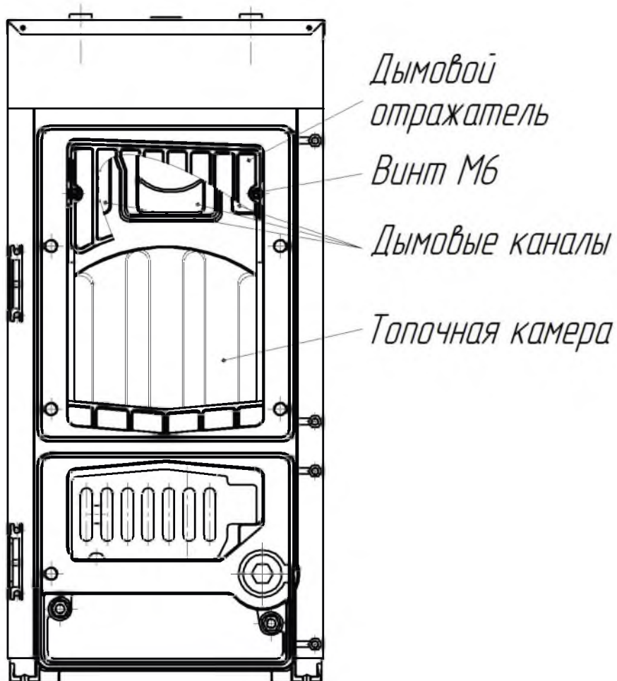
Рис. 16 Чистка дымовых каналов
