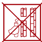
недостаточная тяга (Не используйте котел!)
