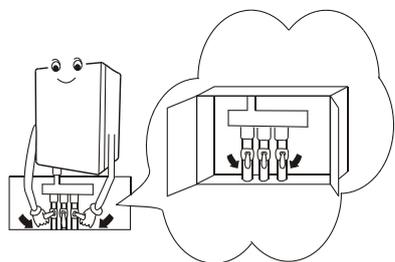
**6. Проверьте положение крана подачи воды.**
