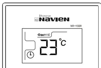
После установки обогрева по таймеру время на дисплее температуры исчезнет и вновь будет изображена настоящая температура. После наступления зафиксированного времени загорится индикатор горения и котёл автоматически включится и начнет работать.
