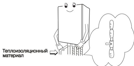
По завершении монтажа водопровода труб системы отопления и труб горячей воды следует затянуть к входные и выходные патрубки котла с помощью гаечного ключа. Во избежание повреждения внешних участков труб и возникновения протечек не прикладывайте чрезмерных усилий при соединении труб.
