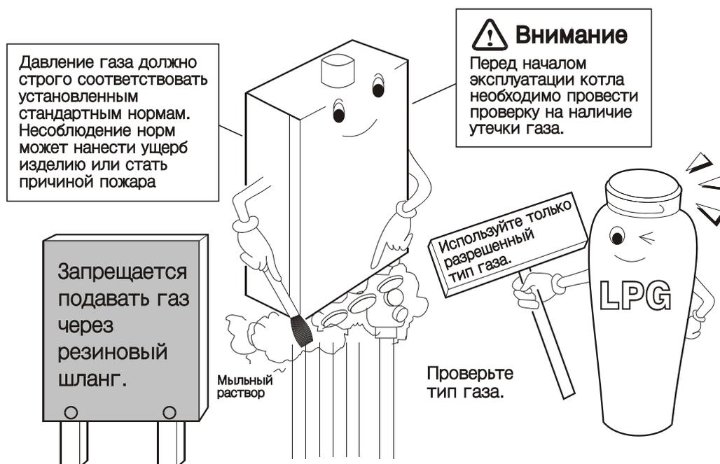
1. Диаметр газовой трубы, подключаемой к устройству, должен составлять 15мм (1/2") или 20мм (3/4") в зависимости от модели.
