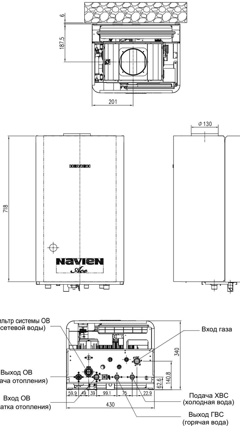
Диаметр подводящих труб указан в разделе технических характеристик
