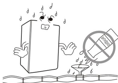
Монтаж труб следует выполнять только после их полной очистки. В трубах загрязняющие вещества могут снизить эффективность системы отопления и системы подачи горячей воды, а также стать причиной возникновения неисправностей.
