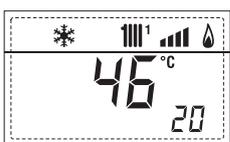
19. Отображение предохранительного термостата ZONA MIX (вход S1) соответственно ВКЛ и ВЫКЛ
