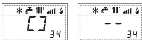
33. Отображение солнечного реле R3 с солнечной платой INSOL (соответственно ВКЛ и ВЫКЛ)
