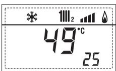
24. Отображение предохранительного термостата с платой ZONA MIX 2 (вход S1) соответственно ВКЛ и ВЫКЛ
