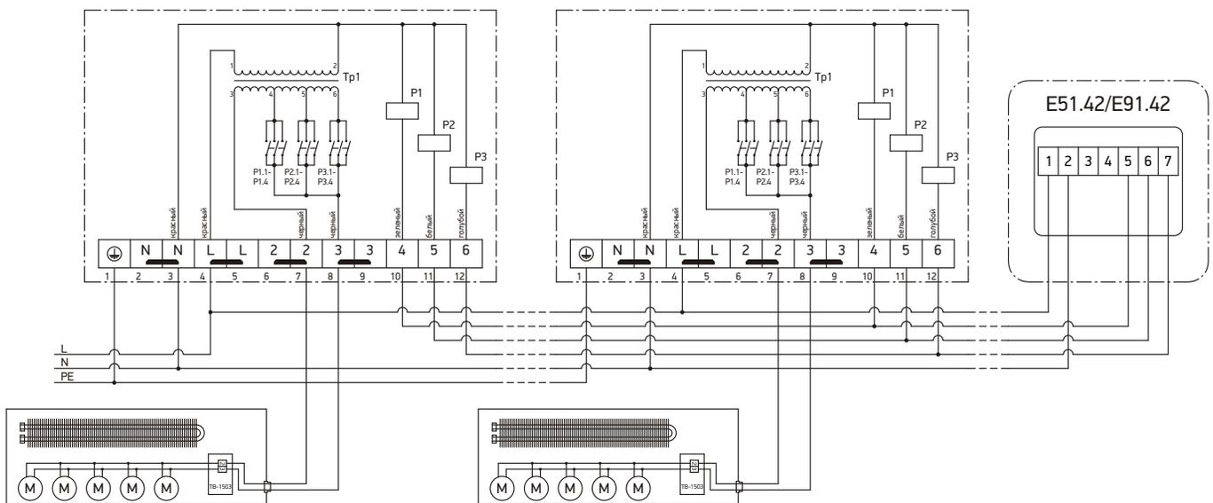
Трансформатор для вентиляторов 220 VAC:
