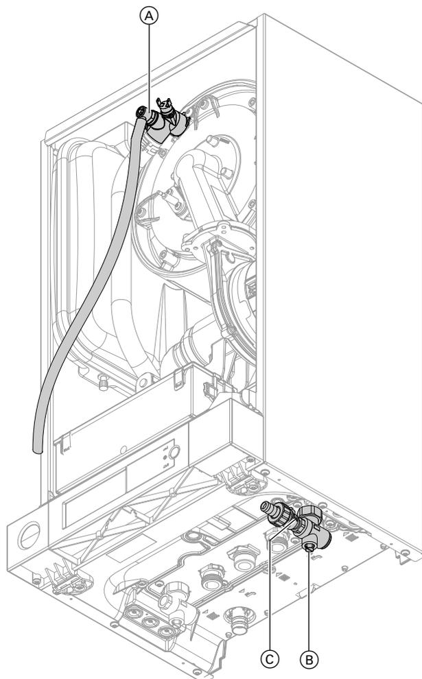
1. Соединить сливной шланг на запорном вентиле (А) со сливным патрубком.
